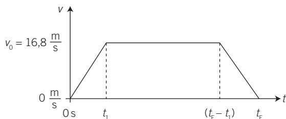
Der Fahrstuhl bewegt sich gleichförmig in einer Zeitspanne  $t_F - 2t_1$  über eine Fahrtstrecke  $l - 2s(t_1)$  mit der Geschwindigkeit  $v_0$ . Die gesamte Fahrtzeit beträgt daher
