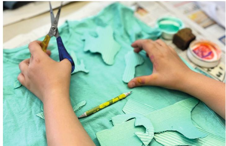
4+5 | Die Druckschablonen aus Polystyrol werden zugeschnitten
