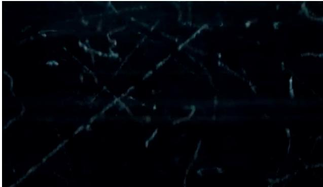
**Abb. 8:** c) Lange, dünne Spuren werden vor allem von Beta-Strahlung und Myonen (aus der kosmischen Strahlung) verursacht.
