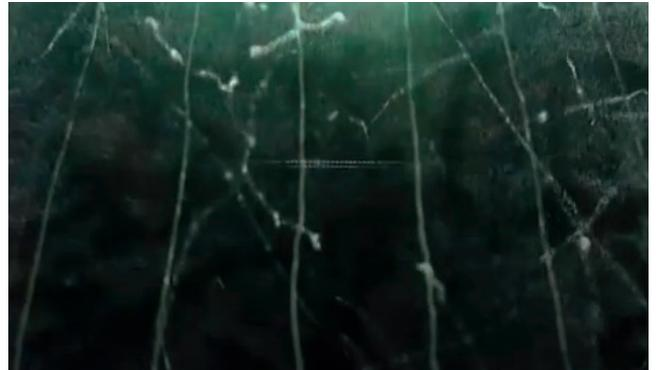
**Abb. 8:** d) Langsame Elektronen (beispielsweise aus der kosmischen Strahlung) hinterlassen gekrümmte, dünne Linien in der Nebelkammer.
