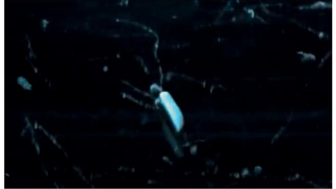
**Abb. 8:** b) Ein Alpha-Teilchen hinterlässt aufgrund seiner großen Masse und kinetischen Energie eine breite Spur in der Nebelkammer. Da es aufgrund seiner Größe aber mit vielen Teilchen zusammenstößt und gebremst wird, ist seine Spur auch relativ kurz.
