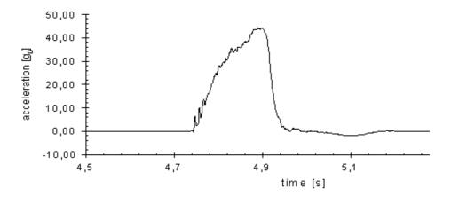
Die Grafik zeigt die Abbremsbeschleunigung während des Eintauchens der Fallkapsel mit 167 km/h in den mit Polystren-Kügelchen gefüllten Abbremsbehälter. Die durchschnittlich wirkende 40fache Erdanziehungskraft über ca. 0,2 Sekunden ist derart sanft, dass alle (selbst empfindliche) Bauteile unbeschädigt bleiben.
