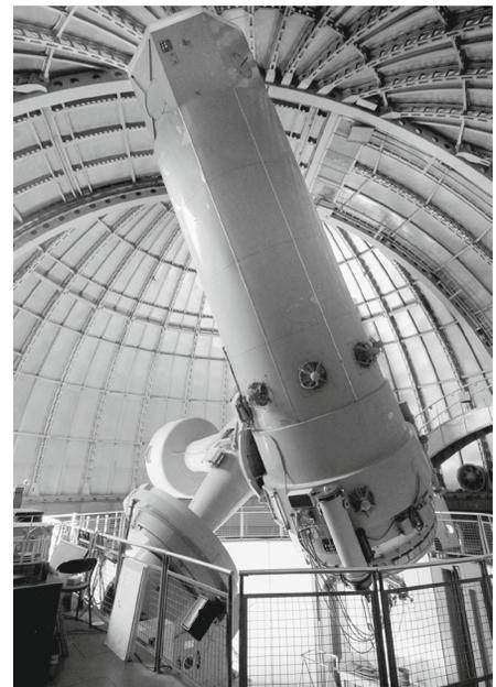
Das im Jahr 1958 in Dienst gestellte 1,93-Meter-Teleskop des Observatoire de Haute-Provence wurde von der Firma Grubb-Parsons in Newcastle (England) gefertigt und bringt mit seinem neun Meter langen Tubus eine bewegliche Masse von 54 Tonnen auf die Waage. Mit diesem Teleskop wurde der erste Exoplanet als Begleiter eines sonnenähnlichen Sterns entdeckt. Lesen Sie dazu unseren Beitrag auf S. 26.
